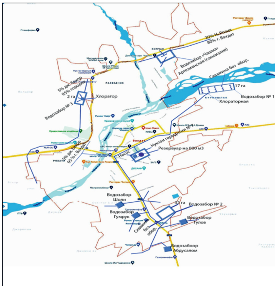
Рис.2 – Примерная ситуационная схема системы водоснабжения города Вахдат
