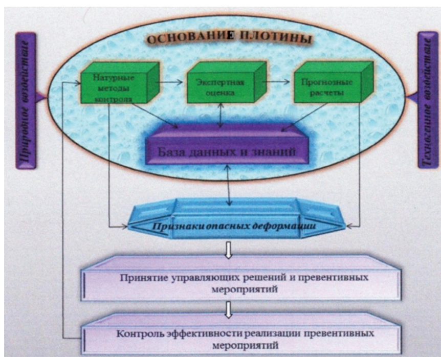
Рис. 1. Общая схема системы мониторинга основания плотины
