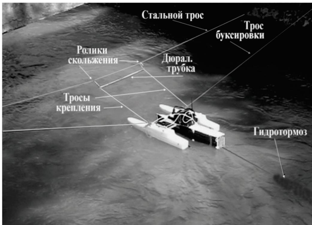
Рисунок 7. Ролики, понтон, гидротормоз.
