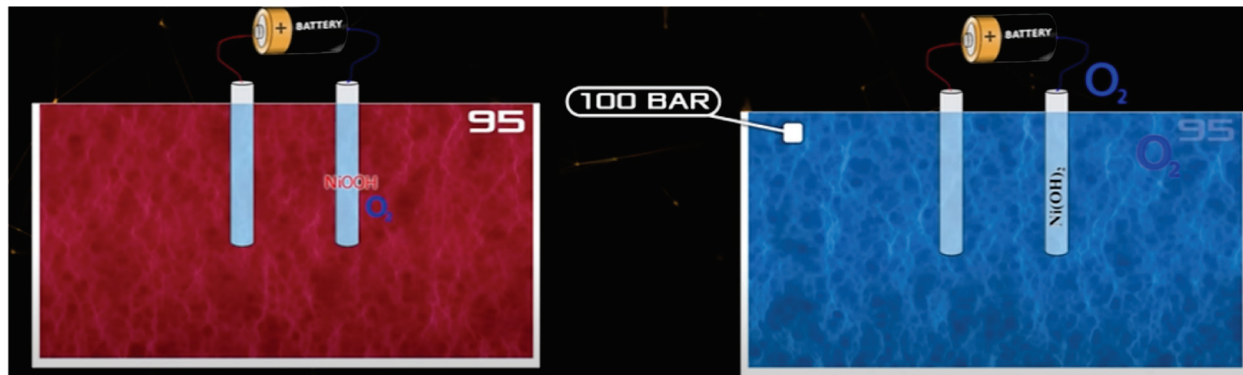
Расми 7. Ҷараёни электрохимиявӣ (то 95°C гарм кардани об, хориҷ кардани оксиген ва ба ҳолати аввалааш баргардонидани анод).
