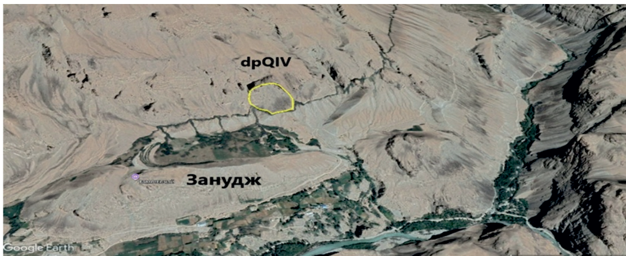
Рисунок 8. Активизация оползнеопасного склона в результате подрезки при строительстве канала в кишлаке Занудж. (Снимок с сайта Google Earth 2022 г.).
