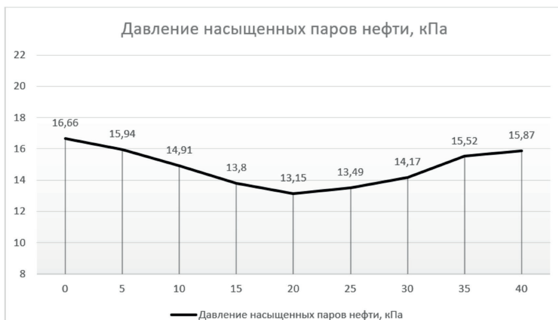
Рисунок 7. Зависимость давления насыщенных паров нефти от концентрации (C_n H_{2n} + lCOO)_2Ca [8].
